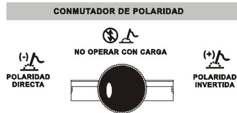
FIGURA 4-4. CONMUTADOR DE POLARIDAD
